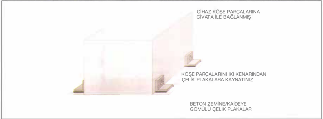
Şekil 13.18. KÖŞE TAKVİYE PARÇASININ YAPIYA KAYNATILMASI
