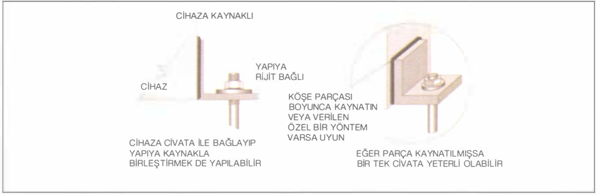
Şekil 13.17. KÖŞE TAKVİYE PARÇASININ EKİPMANA KAYNATILMASI
